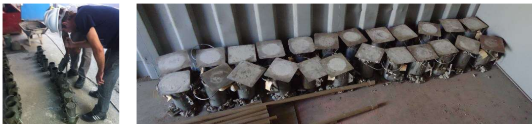
Figura 1 - (a) Moldagem dos corpos de prova e (b) Armazenamento pós moldagem.
